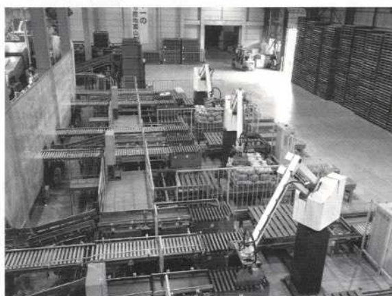
製品はロボットにより積み上げられる
